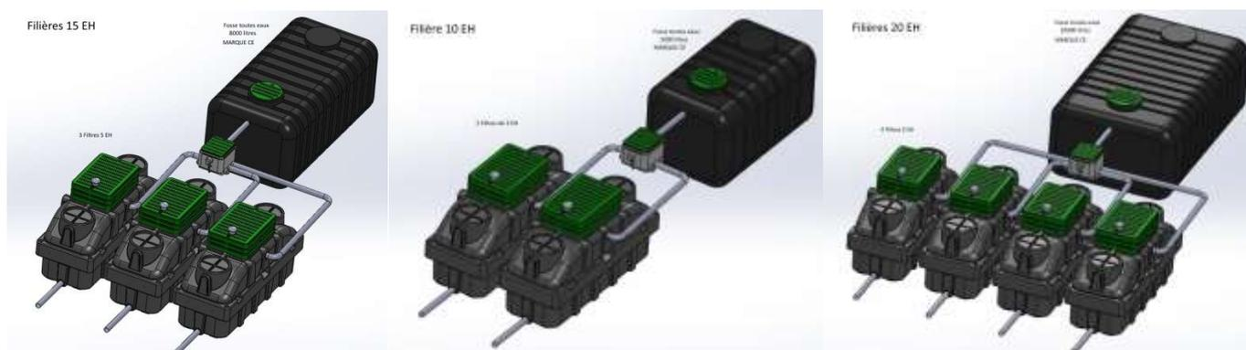
Les dispositifs 10 EH, 15 EH et 20 EH de la gamme « STEPURFILTRE » disposent de la même boîte de répartition en amont des filtres STEPURFILTRE 5 EH installés en parallèles. Les différences entre les modèles résident au nombre de voies et au type de « diffuseurs » installés. La boîte d'alimentation, en fonction du modèle, est préfigurée par PHYTO PLUS en usine.
