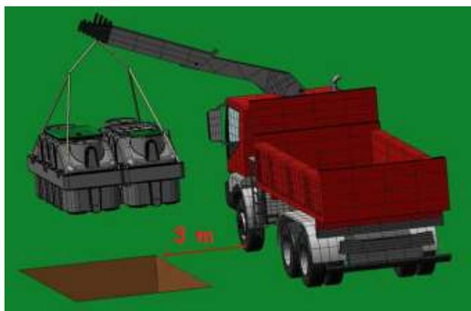
Concernant les filtres des modèles 10EH, 15 EH et 20 EH, ils sont levés en fixant deux sangles aux quatre encoches prévues sur la cuve.
