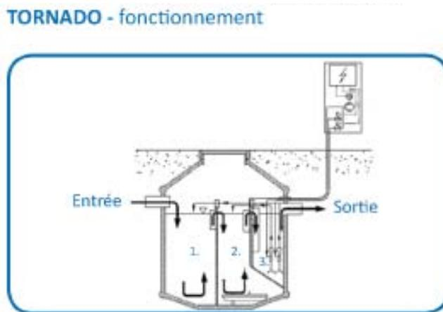
Figure 1 : Montage schématique d'une microstation TORNADO
