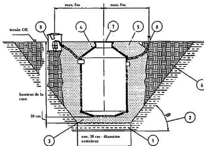
Figure 5 : schéma de la fouille pour BLUEVITA TORNADO
