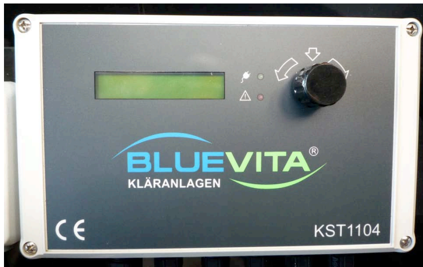
Figure 7 : Panneau de commande KST1104 avec écran à 2 lignes pour l'affichage de l'état du système
