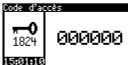
La saisie d'un code d'accès permet de garantir que la mise en service est assurée par un spécialiste. A l'aide de la touche OK et des flèches ↑↓, saisir le code à 6 chiffres, puis confirmer par OK.
