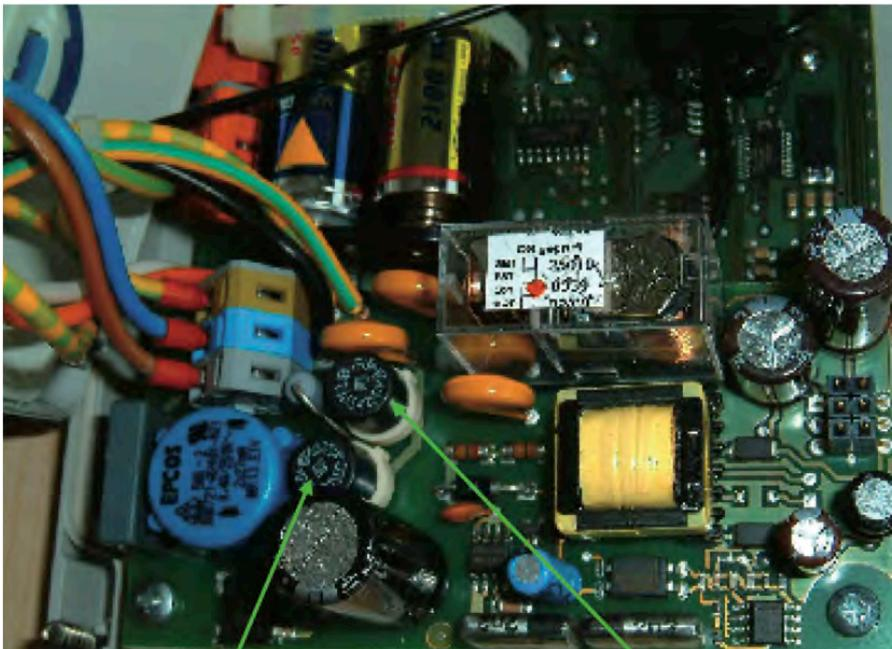
Fusible panneau de commande TR5 ; T0,5A      Protections spéciales compresseur TR5 ; T3,15 A
