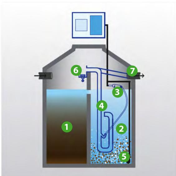
L'eau passe du décanteur primaire (1) dans le réacteur SBR (2) de manière gravitaire.
