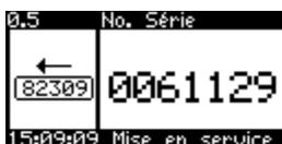
A l'aide de la touche OK et des flèches ↑↓, indiquer le numéro de série qui se trouve sur le kit PUROO® (pas sur le système de commande !) et confirmer chaque chiffre par OK.
