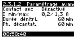
Statut du contact libre de potentiel, limites de courant, dénitrification et durée de la phase de décantation.
