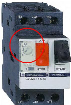
Régler le disjoncteur magnétothermique à l'intensité nominale du moteur, spécifiée sur la plaque signalétique. Vérifier au moyen d'une pince ampérométrique que la consommation électrique est normale. Si elle ne l'est pas, vérifier le sens de tour du moteur, ou vérifier si le moteur est tombé en panne, ou s'est enrayé...
