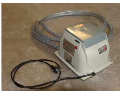
Illustration 3 : Surpresseur à membrane*
