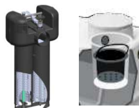
Vue en coupe des préfiltres PF 17 (PTA) et pouzzolane (Urvoy)
