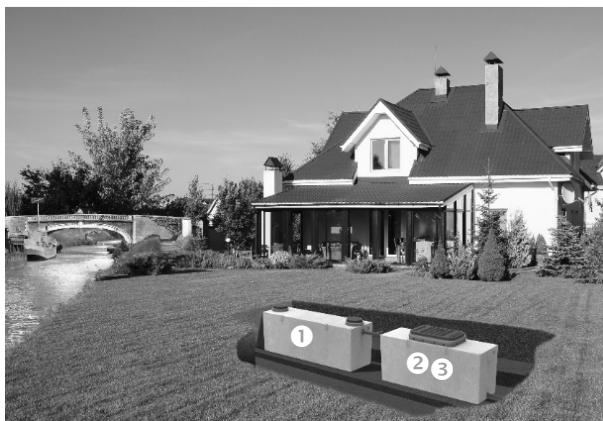
Figure B1 - Exemple de filière ECOFLO® Béton S1
