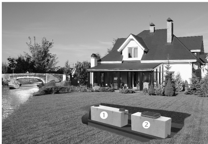
Figure A1 – Exemple de la filière ECOFLO® Béton S1
