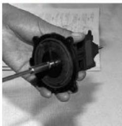
c) Mettre le nouvel aimant avec l'écrou ou la vis.
