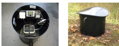
Figure 5: La boîte de commande ou de pilotage externe « standard I »
