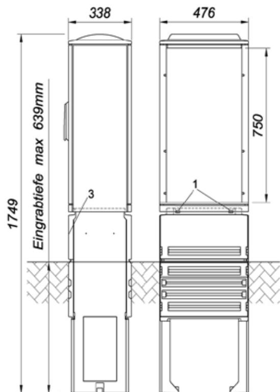
Dimensions de la colonne extérieure de l'armoire de commande extérieure plastique (Art. : 34696 - vendue séparément).
