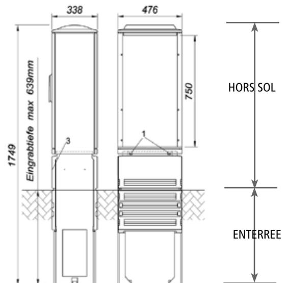
Schéma d'enfouissement de la colonne extérieure de l'armoire de commande extérieure plastique (Art. : 34696 - vendue séparément).
