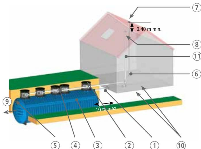
Schéma de raccordement de la ventilation haute pour une micro-station ACTIBLOC® 20EH (18000 DP).
