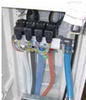
1. Mettre 2 tours de bande Téflon sur le filetage des douilles cannelées des électro-vannes pour éviter les pertes d'étanchéité.
