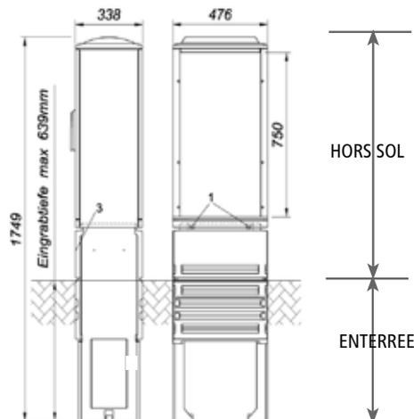
Dimensions de la colonne extérieure de l'armoire de commande extérieure plastique (Art. : 34696 - vendue séparément).
