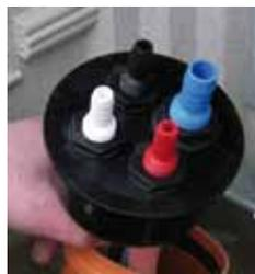
3. Insérer les douilles cannelées dans le bouchon de connexion et fixer les douilles en les serrant avec les écrous.
