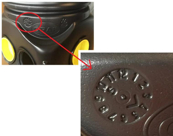
Exemple d'empreinte de traçabilité sur un regard de répartition
