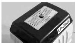
Photo 1 : Desserrer la vis sur le cache-filtre.
