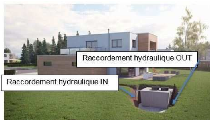
Fig-31 : Raccordement hydraulique modèle 5EH monocuve 3m 3
