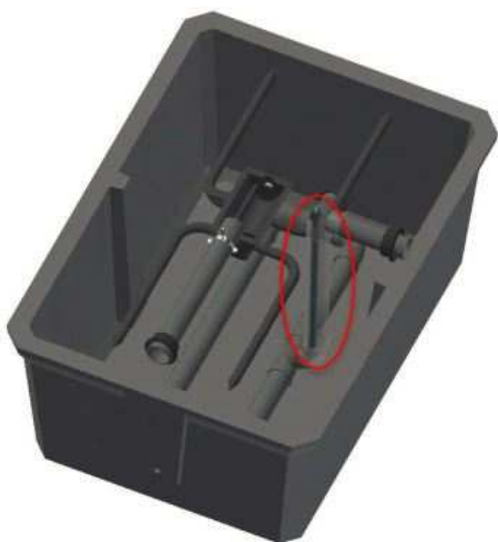
Fig-15 : Position de la sonde de niveau dans la cuve
