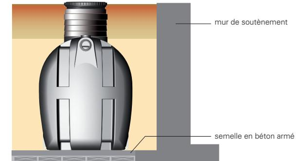
**DANS LES CAS OÙ UNE DALLE DE RÉPARTITION, UN MUR DE SOUTÈNEMENT OU UNE SEMELLE EN BÉTON EST NÉCESSAIRE, UNE ÉTUDE PRÉCISE, QUI PREND EN COMPTE LES FACTEURS EXTERNES TELS QUE LE POIDS DE LA CHARGE, LA FRÉQUENCE DE LA CHARGE ROULANTE, LES POUSSÉES LATÉRALES, LA HAUTEUR DE LA NAPPE PHRÉATIQUE... DOIT ÊTRE MENÉE. NOUS VOUS CONSEILLONS DE FAIRE APPEL À UN BUREAU D'ÉTUDES COMPÉTENT.**
