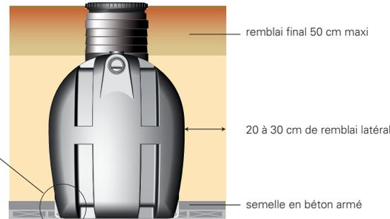
Pour le filtre, insérer 1 ou 2 fers à béton diamètre 16 mm avant sa mise en fouille.
