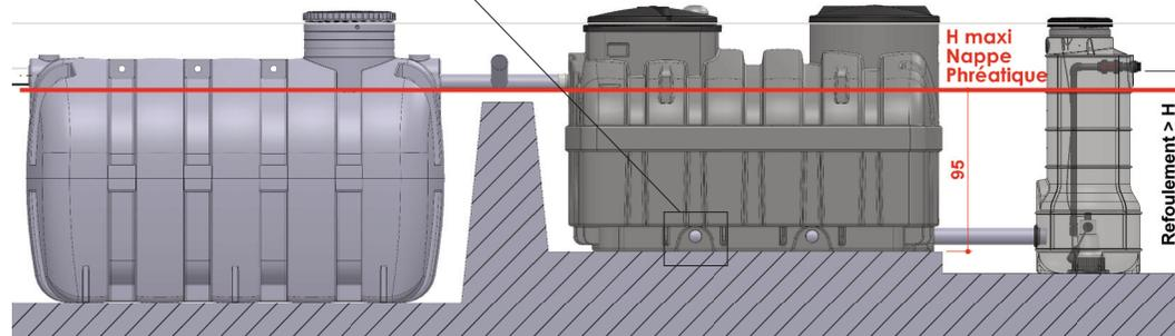
Les eaux traitées en sortie de dispositif sont relevées à une hauteur supérieure à la hauteur de nappe déclarée. Le poste de relevage disposé en aval est installé conformément à l'article 6.3 de la norme NF DTU 64.1, et toutes les précautions seront prises pour les raccordements hydrauliques (étanchéité à vérifier avant remblai) et pour éviter la remontée du cuvelage (lestage).
