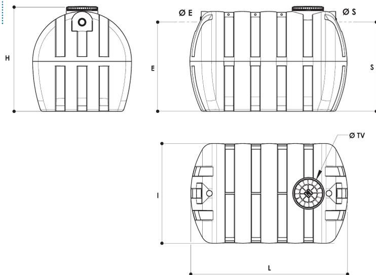
La hauteur en cm de remblai au-dessus de la fosse septique toutes eaux FAN est de 50 cm au maximum
