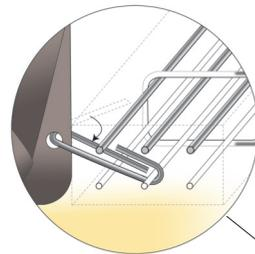
*L'épingle peut être un fer Tor diamètre 6 mm minimum, que l'on tord au moment de la pose.*
