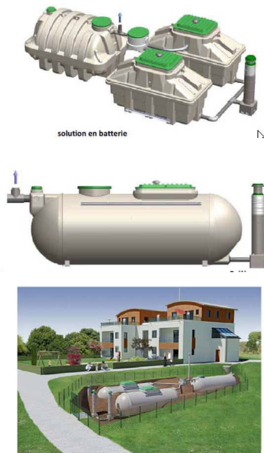
Figure 38 : 3 exemples de filières "Filtre à coco PTA"
