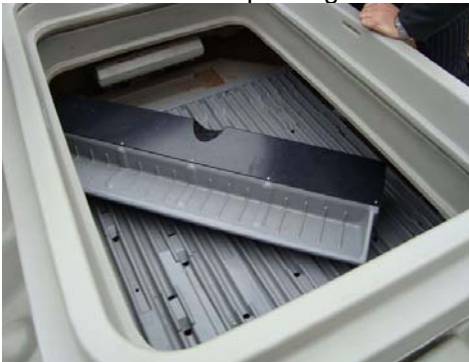
Figure 8 : Vérification horizontalité coco + mise en place auget et plaques
