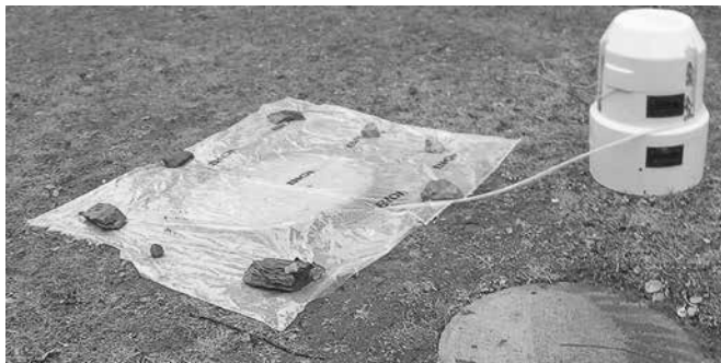
FIGURE 12-9 : PROTECTION DU POINT D'ÉCHANTILLONNAGE
