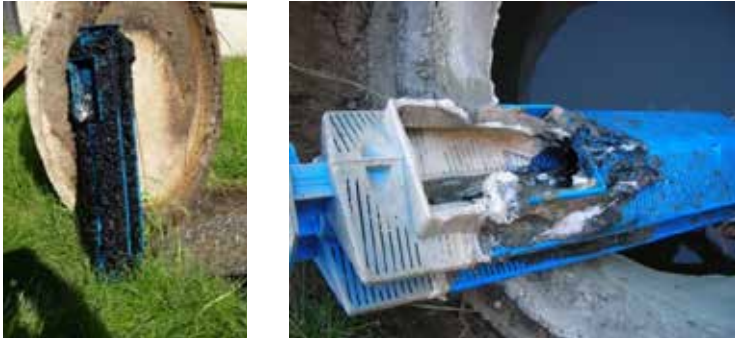
FIGURE 5-2 : PRÉFILTRE APRÈS NETTOYAGE
