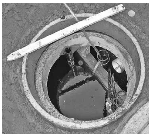
FIGURE 12-8 : PROTECTION DE LA LIGNE DE SUCCION DE L'ÉCHANTILLONNEUR COMPOSÉ
