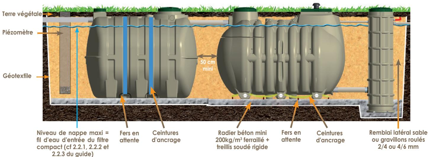
**Remarque :** Dans le cas où la filière HYDROFILTRÉ® 2 serait posée sans poste de relevage, le niveau de la nappe maxi devra se situer en dessous du fil d'eau de sortie du filtre compact (traitement secondaire).
