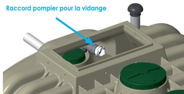
Dans le cas d'une vidange avec présence de nappe phréatique, il est nécessaire de rabattre la nappe avec une pompe vide cave au niveau du fond de piézomètre afin de limiter les risques de déformation de la cuve.
