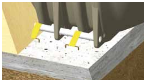
Solution d'ancrage alternative en noyant les tubes d'ancrage dans du béton et en accrochant ces tubes au treillis soudé.
