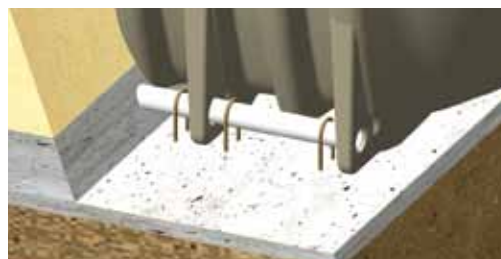
Solution d'ancrage alternative en noyant les tubes d'ancrage dans du béton et en accrochant ces tubes au treillis soudé.
