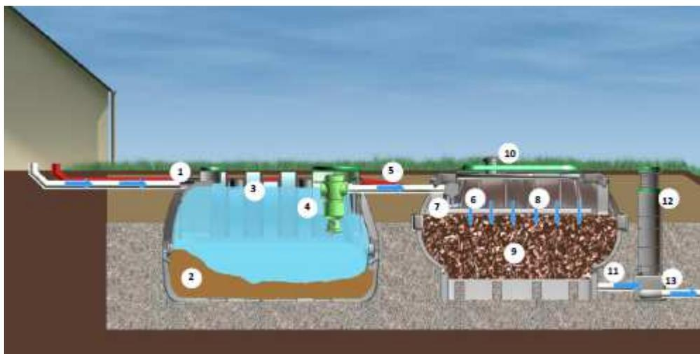
Figure 1 : Filière "Filtre à coco" EPURFIX<sup>®</sup>
