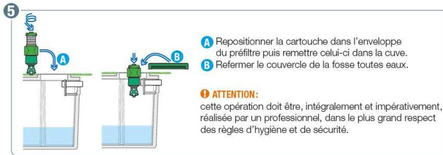
Figure 3 : Exemple du nettoyage du Préfiltre EFT-080
