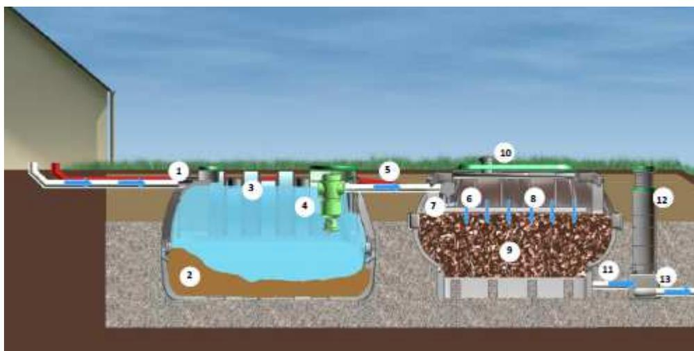
Figure 49 : Identification des points de contrôle/intervention/Epurflo® Mini
