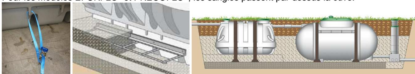
**Figure 14 : exemples d'ancrage**
