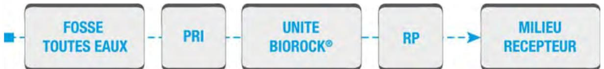
Dans le cas de l'utilisation d'un poste de relevage entre la fosse toutes eaux et le filtre, il est nécessaire d'ajouter un regard de disconnection (chasse à auget ou répartiteur de notre gamme BIOROCK® par exemple) après le poste de relevage afin que l'entrée de l'effluent dans le filtre se fasse par gravité.
