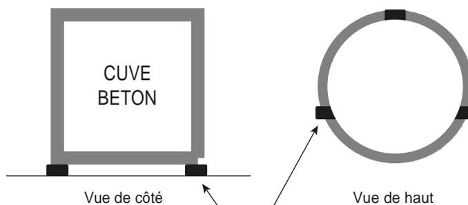
Les 3 points d'appui situés au sommet de la station correspondent aux 3 points d'appui de l'ensemble sur le sol.
