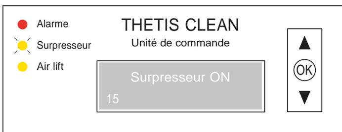
Le LED rouge signale une alarme qui prévient des dysfonctionnements du dispositif.
