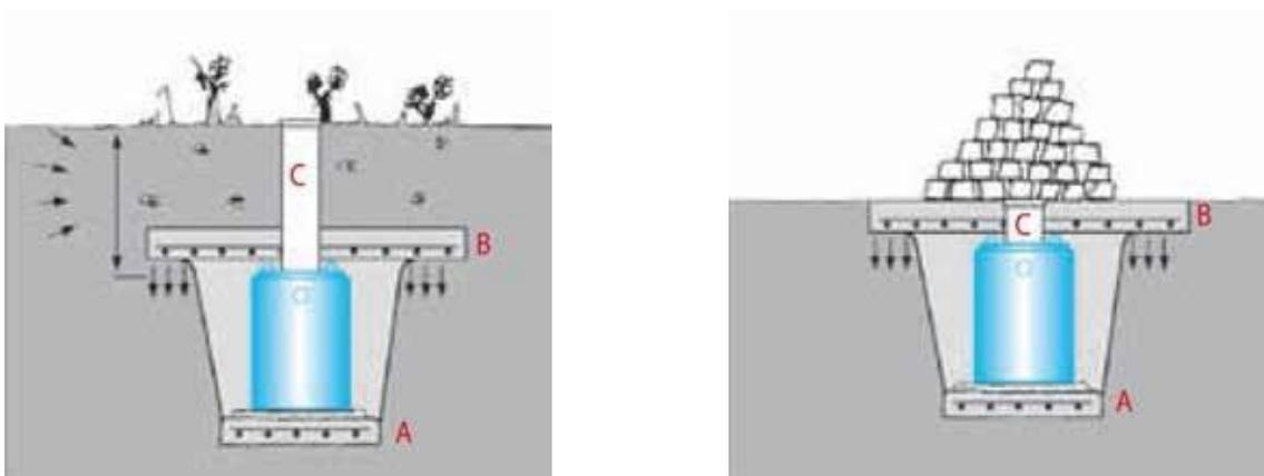
A. Un radier en béton armé sous la cuve pour correctement diffuser la charge sur le fond
