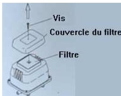
Nettoyer le filtre à l'aide d'un compresseur à air.
