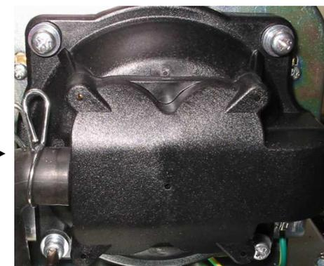
**Monter la membrane en utilisant 2 nouveaux écrous et 2 rondelles neuves**
