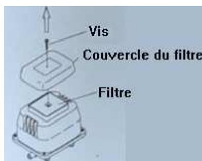
Nettoyer le filtre à l'aide d'un compresseur à air.
