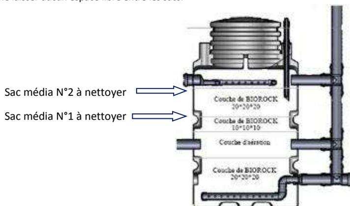
La fréquence de ces opérations de nettoyage et/ou de remplacement du média filtrant est en fonction de la quantité et de la qualité des effluents en sortie de la fosse toutes eaux. C'est la raison pour laquelle il est impératif de bien entretenir la fosse toutes eaux et le filtre décolloïdeur.
