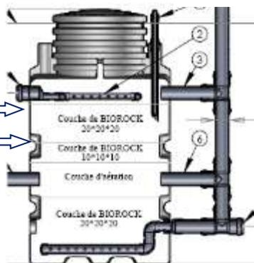
La fréquence de ces opérations de nettoyage et/ou de remplacement du média filtrant est en fonction de la quantité et de la qualité des effluents en sortie de la fosse toutes eaux. C'est la raison pour laquelle il est impératif de bien entretenir la fosse toutes eaux et le filtre décolloïdeur.
