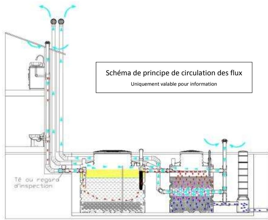
Les matériels et matériaux utilisés dans le système BIOROCK sont insensibles à la corrosion. En cas de remplacement, utiliser impérativement les produits d'origine. Les canalisations sont en PVC vendues dans le commerce à des fins d'assainissement. Toute la visserie et pièces en métal sont en acier inoxydable. La cuve est en polyéthylène résistant aux UV et insensible à la corrosion, la durée de vie est supérieure à 30 ans selon les conditions d'installation et d'utilisation.
