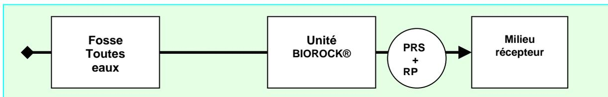
Les postes de relevage préfabriqués permettant de relever les effluents situés en aval de l'unité de traitement peuvent être conformes à la norme NF EN12050-1. Se reporter à l'article 7.4 du DTU64.1 et à la notice du fabricant.
