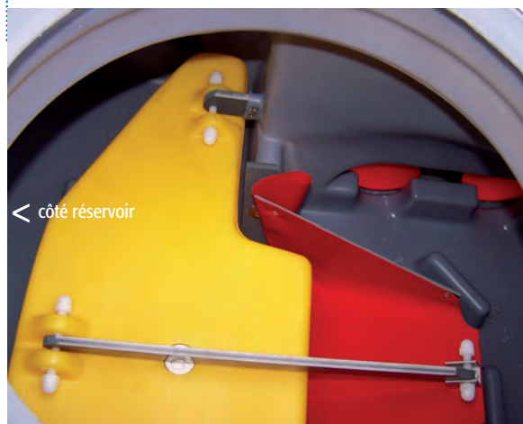
Position fermée (position de repos) (Flotteur niveau bas, trappe fermée)
