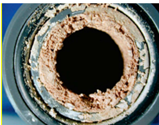
Figure 6 : Exemple de colmatage des canalisations d'évacuation des urines par les précipités (Eawag, 2007)
