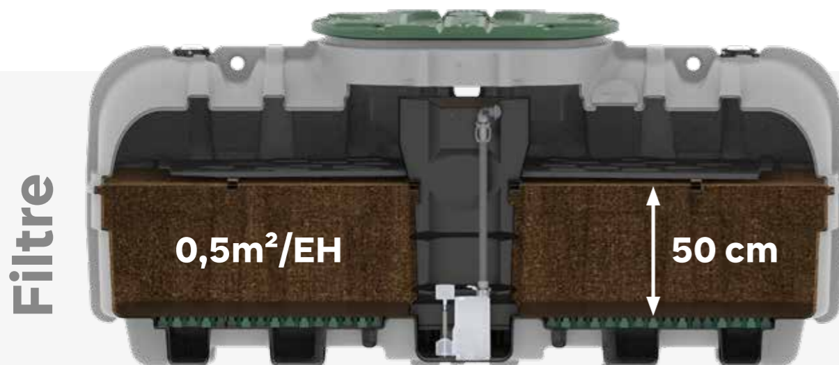
Unité de traitement secondaire : filtre de surface horizontale de 0,5 m 2 /EH (mesurée en surface du massif filtrant) et 50 cm de hauteur de milieu filtrant à base de fragments de coco
