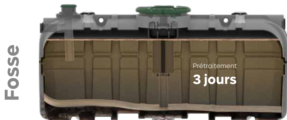
Unité de traitement primaire type fosse toutes eaux : temps de séjour hydraulique minimum de 3 jours
