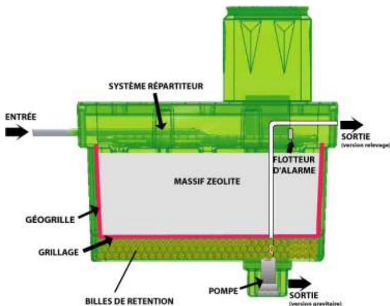
Le système de filtration biologique FILTROZ permet un abattement complémentaire de la pollution résiduelle en sortie de traitement et une baisse des matières en suspension.
