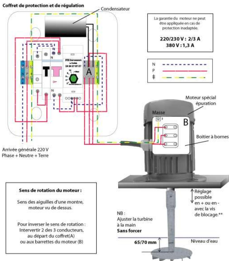
\*\* Le réglage de l'immersion de la turbine se fait en priorité en utilisant les possibilités du support moteur, de coulisser en bas ou en haut dans son propre support. Pour cela, dévisser légèrement les quatre vis inox de fixation, régler le support horizontalement afin de laisser une colonne d'eau de 65 à 70 mm au dessus de la turbine. Resserrer et bloquer les écrous.
