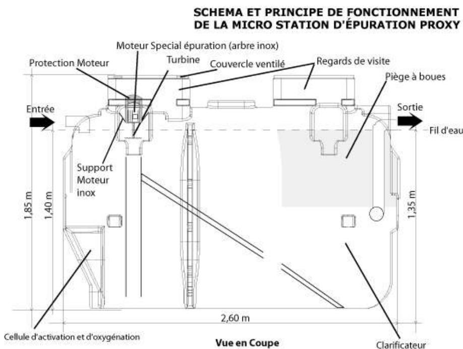
La micro station travaille sur le principe d'une oxygénation forcée (boues activées).
