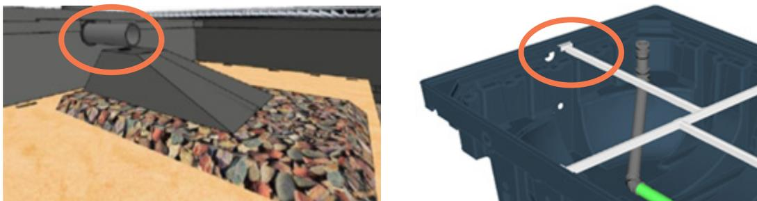
Zones à percer pour les entrées lors d'alimentation gravitaire ou par chasse hydraulique (diamètre 100 mm)
