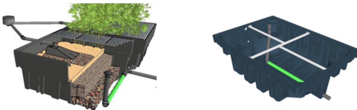
Zones à percer pour les sorties (à gauche : modèle bac 2,5 EH / à droite : modèle bac 3 EH)
