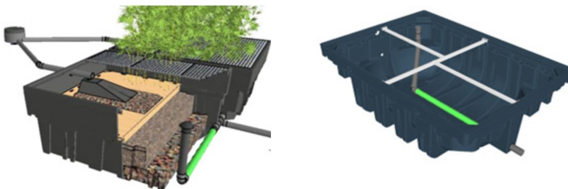
Zones à percer pour les sorties (à gauche : modèle bac 2,5 EH / à droite : modèle bac 3 EH)
