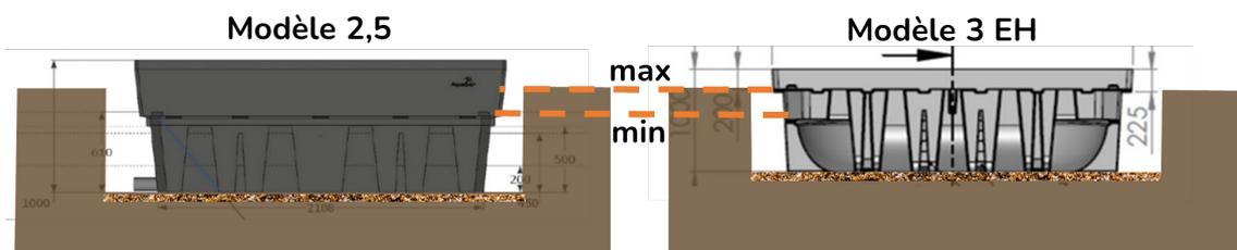
Profondeurs minimum et maximum de fouille en fonction des modèles de bac (2,5 et 3 EH)
