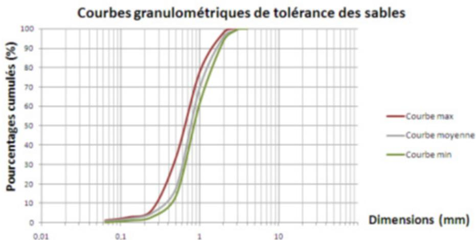
Courbe granulométrique du média filtrant du filtre végétalisé à écoulement vertical
