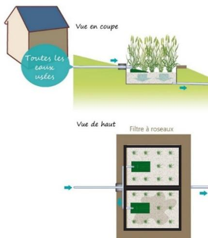
Le filtre à écoulement vertical des Jardins d'Assainissement® ROSEAUX de capacité 5 et 6 EH est composé de 2 bacs d'étanchéité préfabriqués en PE, correspondant à chacun des compartiments alimentés alternativement.
