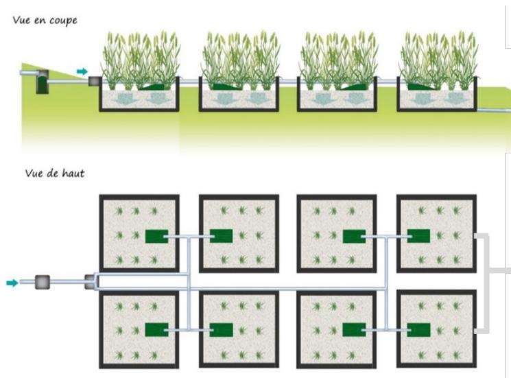
Le filtre à écoulement vertical du Jardin d'Assainissement® ROSEAUX de capacité 20 EH est composé de 8 bacs d'étanchéité préfabriqués en PE, alimentés quatre par quatre alternativement.
