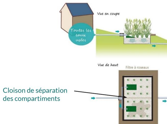
Le filtre à écoulement vertical du Jardin d'Assainissement® ROSEAUX de capacité 3 EH est composé d'un seul bac d'étanchéité préfabriqué en PE, divisé en 2 compartiments par une cloison non étanche disposée au milieu du filtre.
