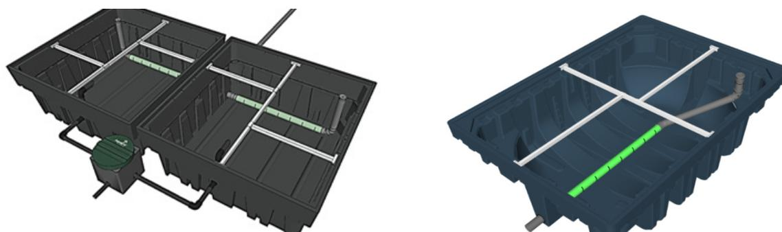
Positionnement du réseau de drainage/ventilation (à gauche : modèle bac 2,5 EH / à droite : modèle bac 3 EH)
