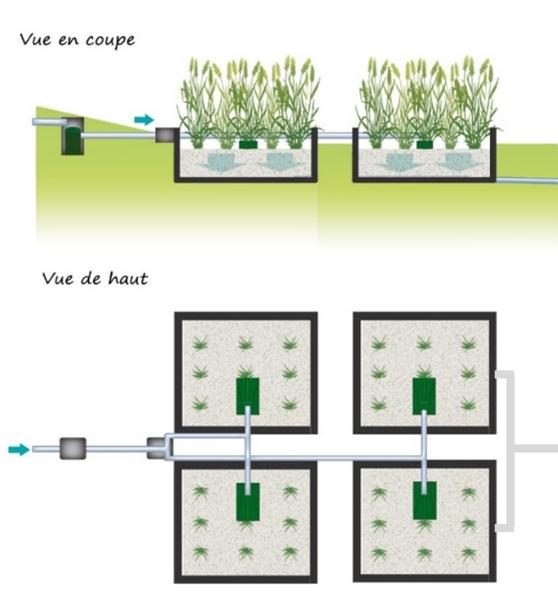
Le filtre à écoulement vertical des Jardins d'Assainissement® ROSEAUX de capacité 10 et 12 EH est composé de 4 bacs d'étanchéité préfabriqués en PE, alimentés deux à deux alternativement.
