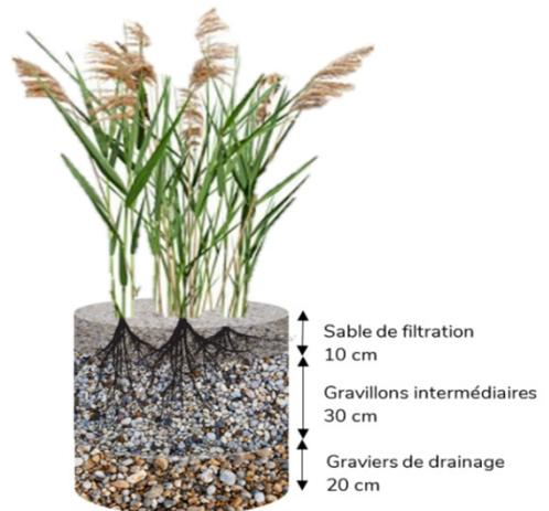
Description des couches de granulats de filtration et de drainage du filtre végétalisé à écoulement vertical
