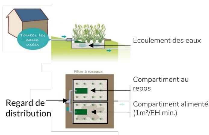
Schéma simplifié du filtre à écoulement vertical = filtre à roseaux
