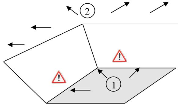
Figure 8 : application de la géomembrane dans les angles du bassin
