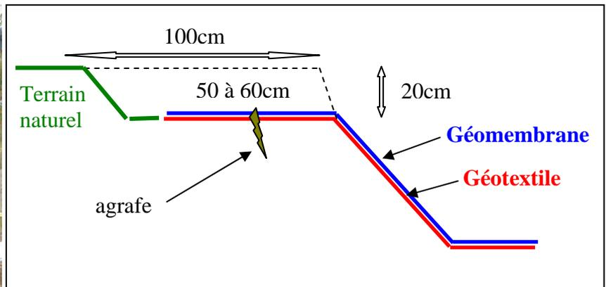
Figure 9 : Ancrage de la géomembrane et du géotextile
