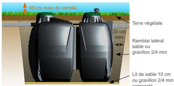
Le compactage par engin mécanique n'est pas autorisé. Terminer le remblayage avec de la terre végétale jusqu'au niveau des couvercles.
