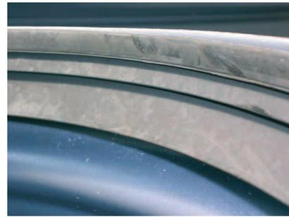
Les languettes du joint doivent être orientées vers le fond de cuve.
