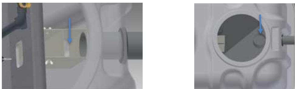
Fig-15 : Dispositifs d'échantillonnage des stations Oxyfix® LG-90 mono et bicuve
