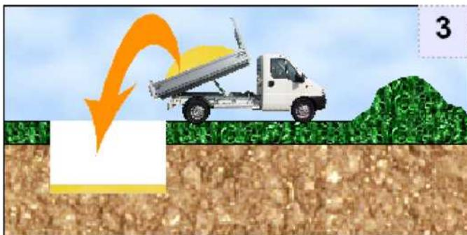
**3. Recouvrir le fond de fouille de 10 cm de sable ou de sable stabilisé.**
