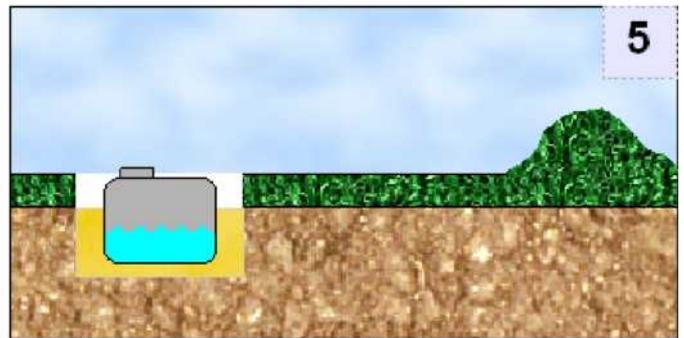
**5. Remblayer latéralement (épaisseur 20 cm) avec du sable, exempt de tout objet pointu ou tranchant, au fur et à mesure de la mise en eau de l'appareil pour équilibrer les pressions.**
