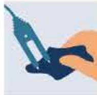
Vérifiez régulièrement les pointes de mesure du capteur d'eau. Si nécessaire, nettoyez les extrémités métalliques avec un chiffon humide. Vérifiez régulièrement le bon fonctionnement du WD 1000 en pontant le capteur d'eau avec une pièce métallique.
