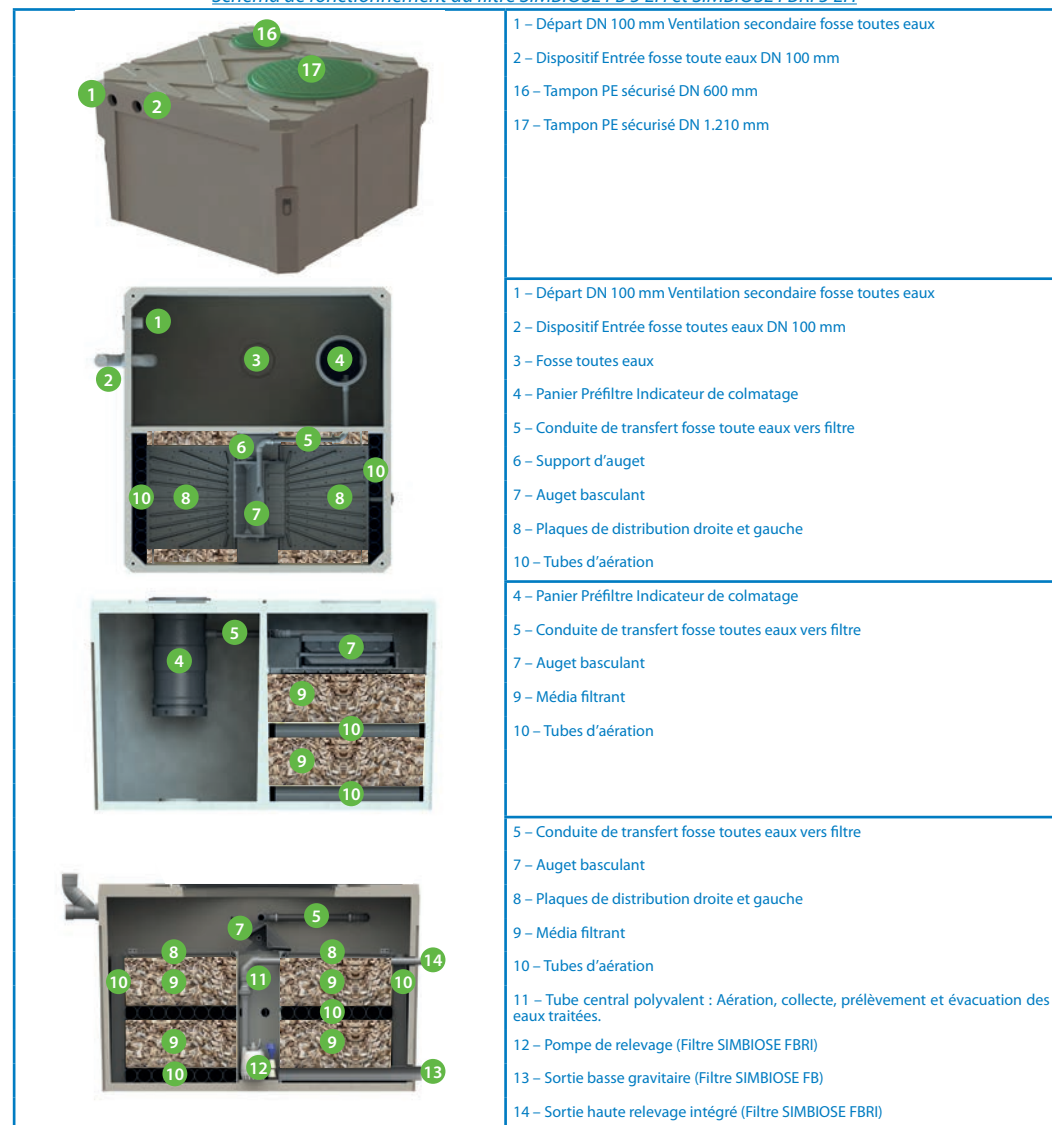
Schéma de fonctionnement du filtre SIMBIOSE FB 5 EH et SIMBIOSE FBRI 5 EH
