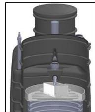
Répartition des effluents - Positionnement du dispositif de dispersion
