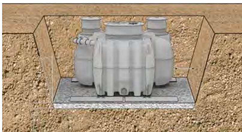
Fig. 29: Filtre en place - terrain humide et/ou difficile avec kit d'ancrage rapide GRAF
