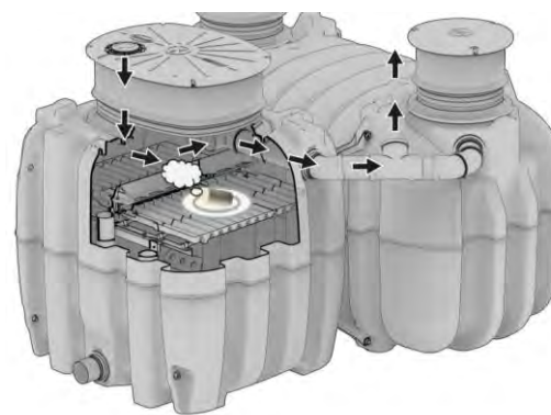
Fig. 44: Test de fumée
