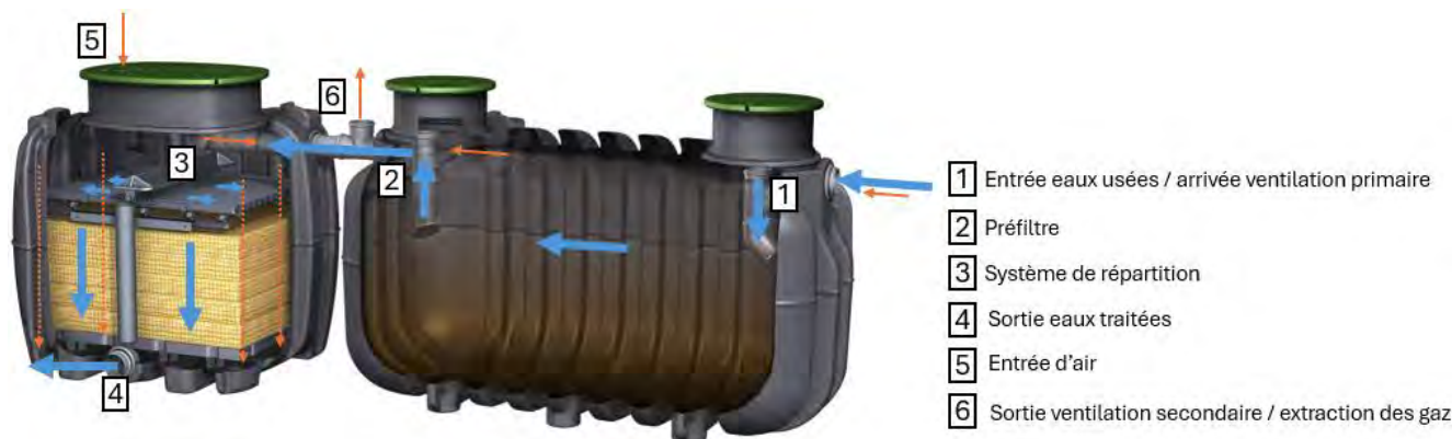
Fig. 38: Circulation de l'eau – Points de contrôle (flux hydraulique en bleu et flux d'air en orange)
