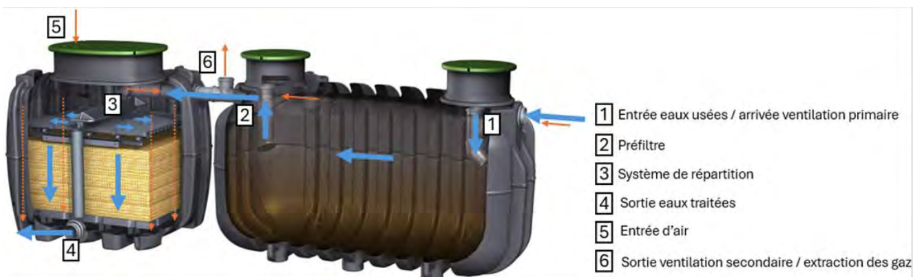
Fig. 51 : Circulation de l'eau – Points de contrôle (flux hydraulique en bleu et flux d'air en orange)
