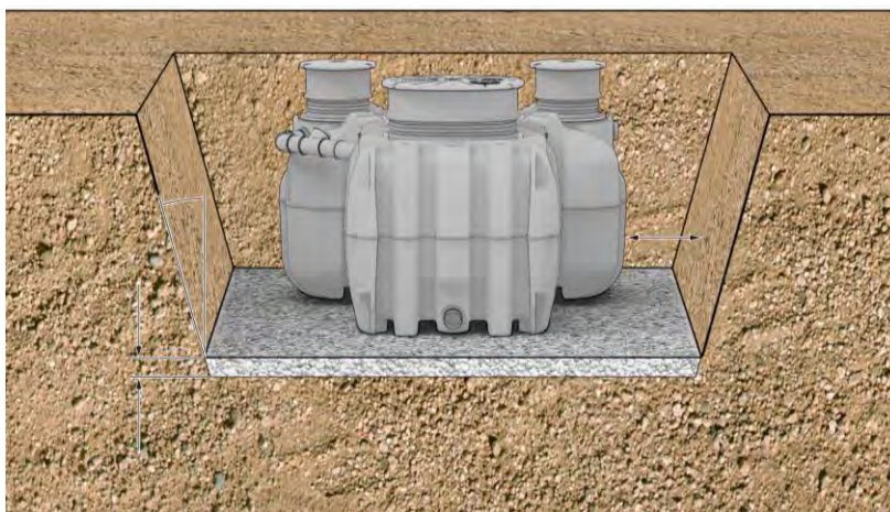
Fig. 30: Filtre en place - Terrain sec
