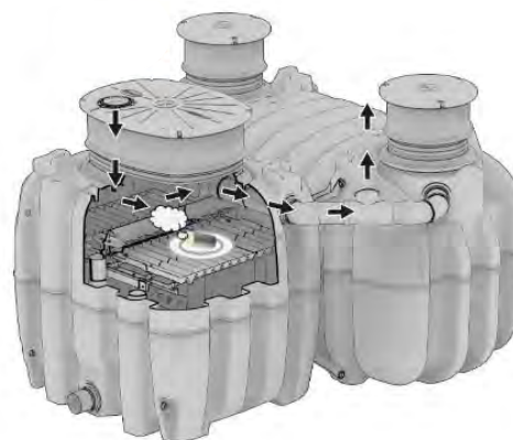
Fig. 64: Test de fumée
