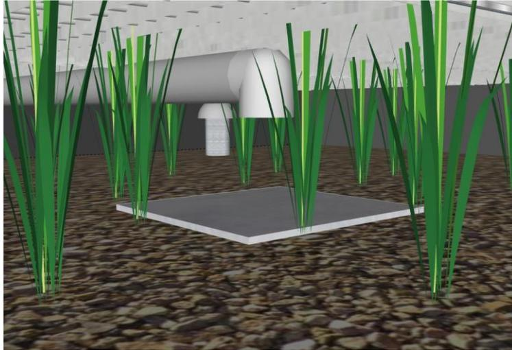
*Le tuyau d'alimentation des eaux usées, le point de distribution et la dalle de répartition dans le filtre vertical.*
