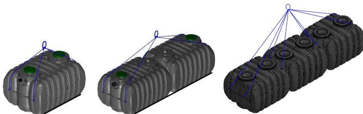
**Ne jamais manutentionner les cuves en utilisant les barres d'ancrages**
