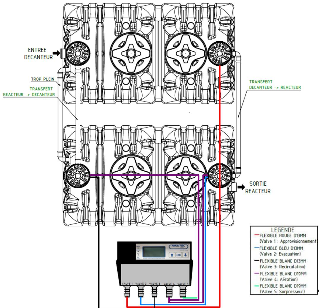
**D.4. MISE EN PLACE DES FLEXIBLES (MODELES 14 à 20EH)**
