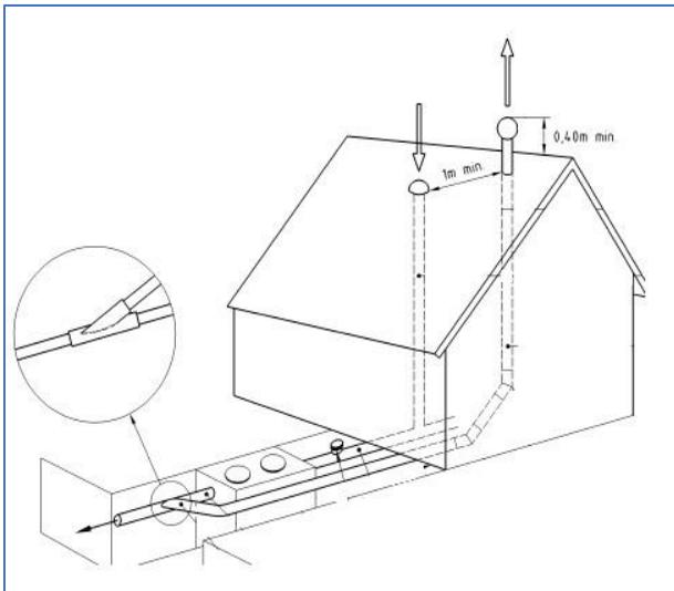
Figure 36 : raccordement des ventilations vers l'extérieur
