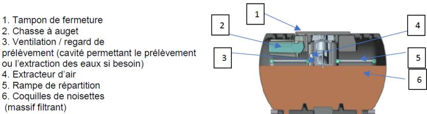
Figure 2 : Principaux composants du filtre compact
