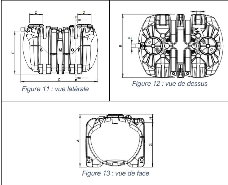
**Tableau 7 : Vues des FTE pour les modèles BIONUT2/6054/8 à 20**
