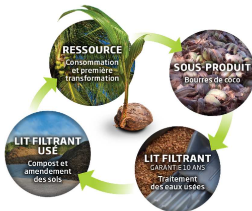
Figure A6 - Cycle de vie du milieu filtrant à base de fragments de coco
