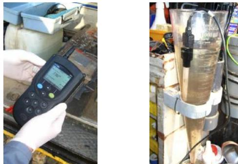
Fig-9 : Mesure du PH et de l'oxygène
