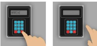
Cependant, l'utilisateur ou le professionnel intervenant sur la station lors des opérations d'exploitation, pourra vérifier le bon fonctionnement des équipements électriques en actionnant le bouton poussoir prévu à cet effet, à l'intérieur de ce coffret de commande (cf. illustrations).
