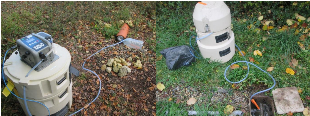
Figure 1 : Préleveur 24 flacons (avec bouteille de prélèvement) et monoflacon (avec seuil)
